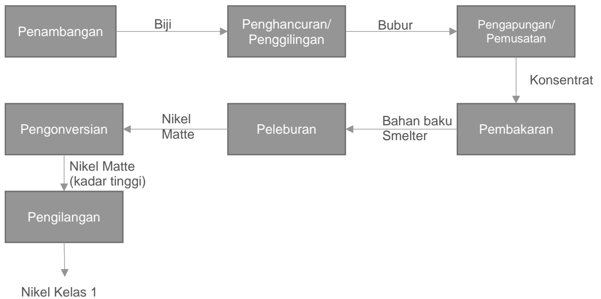
Gambar 3: Rute Pengolahan Khas untuk Mendapatkan Nikel Kelas 1 dari Bijih Sulfida
